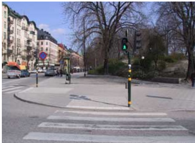
FIGUR 5.23 Fotgjengerovergang ved gangbane som er 3 m eller bredere
