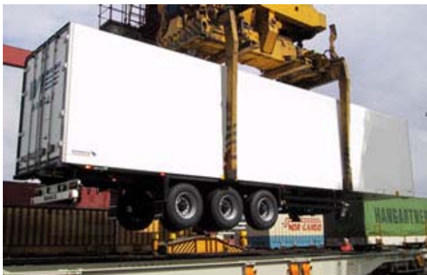
Figur 40: Løft av semi-henger over på tog
