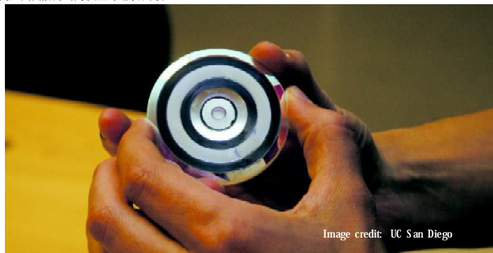
未上涂层的钻石切割的光学透镜
