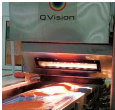
Figur 21. QMonitor (QVision) for automatisk måling av fettinnhold, pigment og farge i pre-rigor laksefilet (Norsk sjømat, 5-2008).
