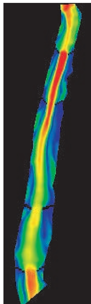
Hastighetsfordeling med modellerte buner og renner
