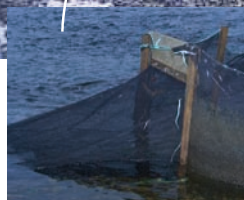
Forsøksinnhengning i Nidelva under nedtapping fra 110 - 30 m 3 /s. Fisk som ikke strander kan rømme til notposen (innfelt).
