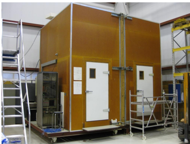
Figur 3. SINTEF Byggforsks hot box ved Lerkendal-laboratoriet i Trondheim.
