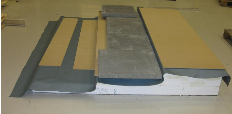
Figur 4. Liming av takfolie til EPS.
