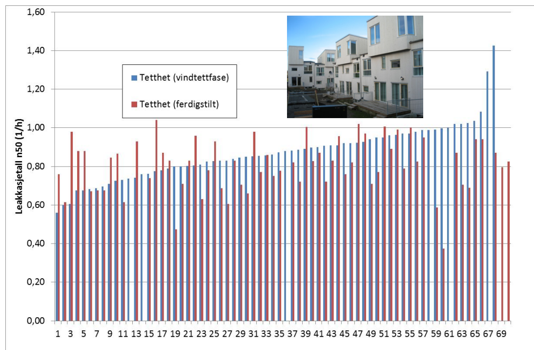
Figur 6 Lufttetthetsmålinger fra 68 boenheter i boligfeltet Jåtten øst. Prosjektet ble ferdigstilt i 2008. 6
