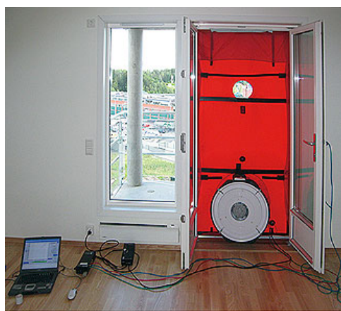
Figur 2 Måling av lufttetthet Byggforskserien 720.035 Måling av bygningers lufttetthet.
