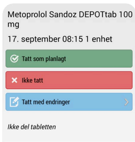
Figur 11: Fargevalg – rød og grønn bør ikke stå sammen da fargeblinde ikke vil se forskjell på disse. Bra at ikoner og tekst brukes i tillegg, dette gjør at det ikke er like prekært.
