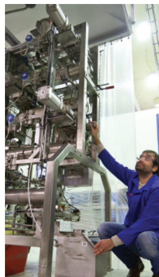
En torrefieringsreaktor – termisk forbehandling av biomasse som gir forbedrede egenskaper.
