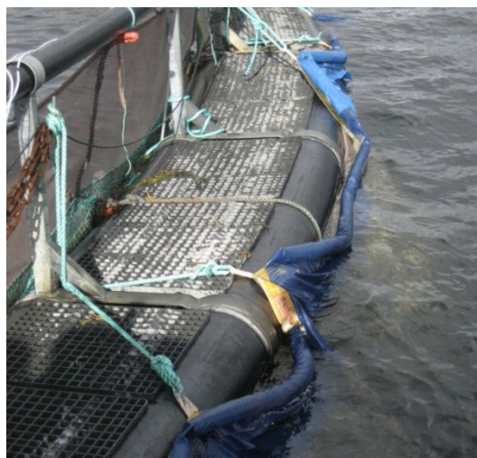
Figur 24. Skjørt montert på Helligholmen der innfestingene skaper folder i skjørtet.
