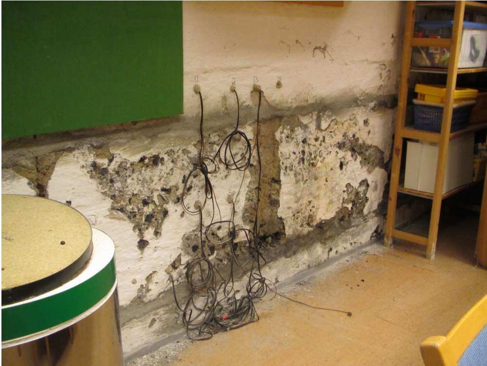
Fig.4.2.4 Plassering av målesensorer i veggen.
