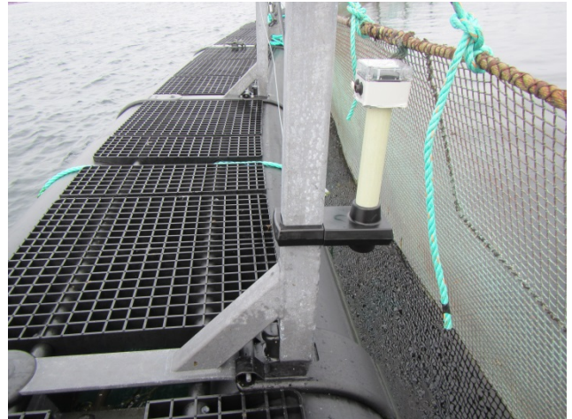
Plassering av instrumentskap og tre-akset akselerometer/gyro på flytekrage
