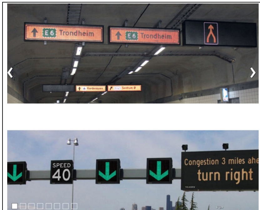
Figur 19: Eksempler på fullgrafiske skilt (DMS Dynamic Message Signs basert på LED teknologi)
